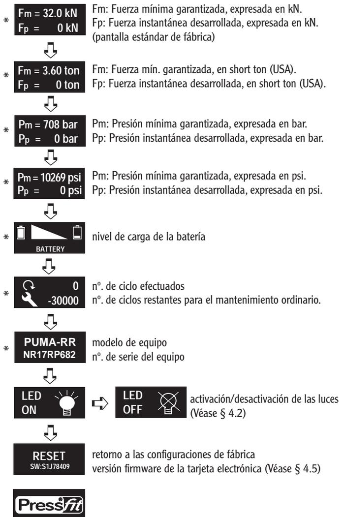
\* Estas pantallas pueden configurarse como "ventana principal" que se puede visualizar constantemente en la pantalla y en cada utilización del equipo. Para ello, una vez visualizada la pantalla elegida, mantenga el dedo en la tecla (6) hasta escuchar un "bip prolongado" de confirmación.
